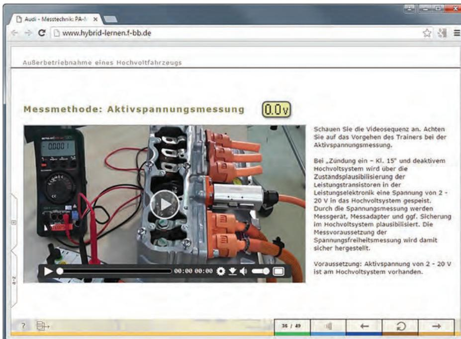
Abb. 6: Lehrvideo zur Demonstration einer Methode zur Spannungsfreimessung
