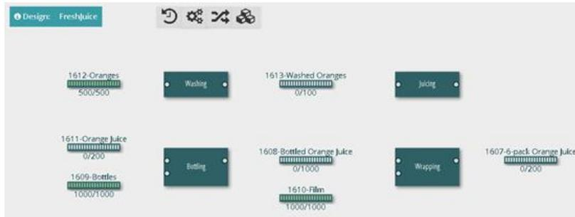
b) Danach müssen die Merkmale der Inputs und Outputs für jede Maschine festgelegt und die Verbindungen zwischen Maschinen und Trägern hergestellt werden. Die Kreise auf der linken Seite jeder Maschine sind Anschlüsse für Inputs, jene auf der rechten Seite sind Anschlüsse für Outputs.
