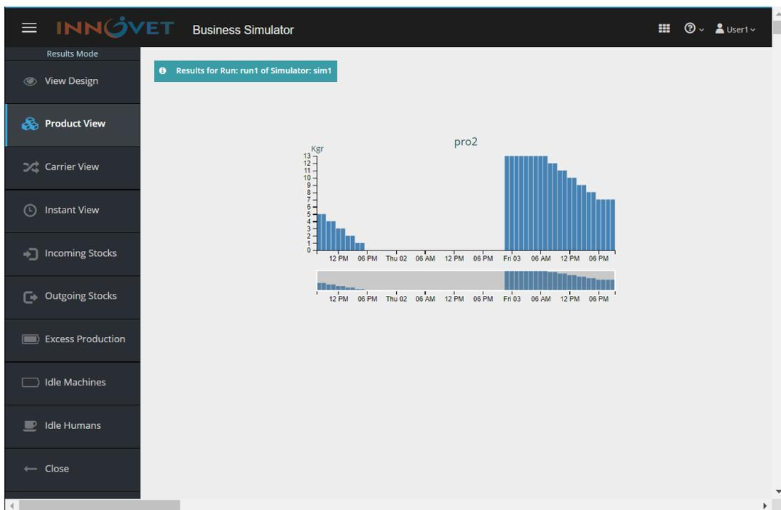
In der Arbeitsumgebung erscheint ein Diagramm mit den Ausbringungsmengen des Produkts *pro2*. Die vertikale Achse repräsentiert die Menge des Produkts, die horizontale Achse den Zeitablauf. Der Nutzer kann die dargestellte Zeitspanne durch eine entsprechende Auswahl auf der dynamischen Skala unterhalb des Diagramms anpassen.
