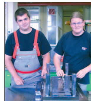
Sebastian (links) und Georg (rechts) warten ein Folgeschnittwerkzeug, mit dem Aluminiumradzylinder aus Blechstreifen gestanzt werden.
