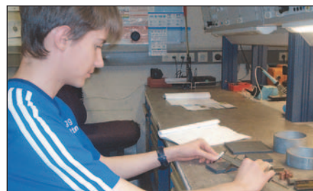
Hubert Schmidt prüft, ob die Maße am Lagerschild des Elektromotors mit der Planzeichnung übereinstimmen.
